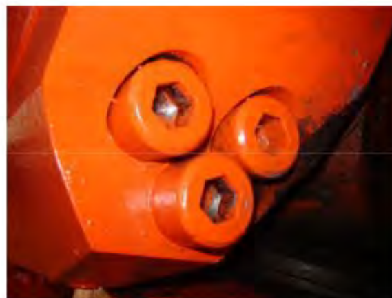
Bulones con sobre torque
