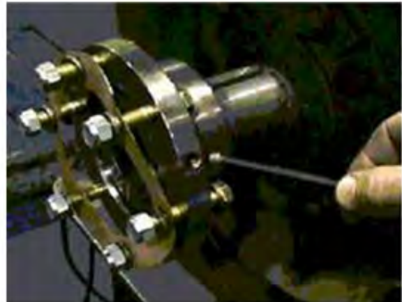
Apriete con llave torquimétrica
