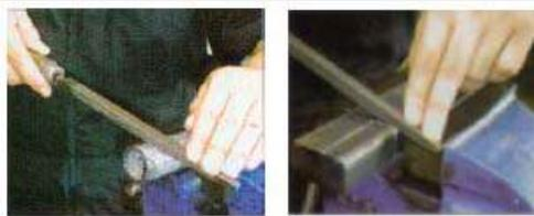
✓ Aplicar presión en la carrera hacia delante, quitar en la carrera de regreso, aplicar menor velocidad de corte en materiales duros y disminuir la velocidad al terminar el corte.
